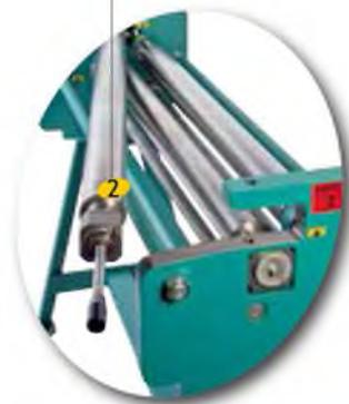
Ручной или электрический привод прижимного вала
