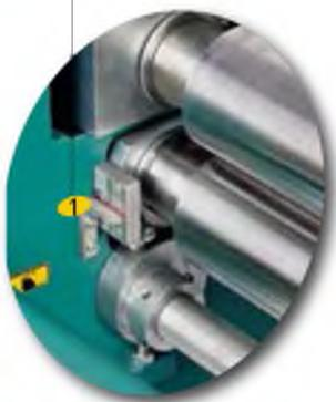
Заготовка легко снимается благодаря боковому открытию
